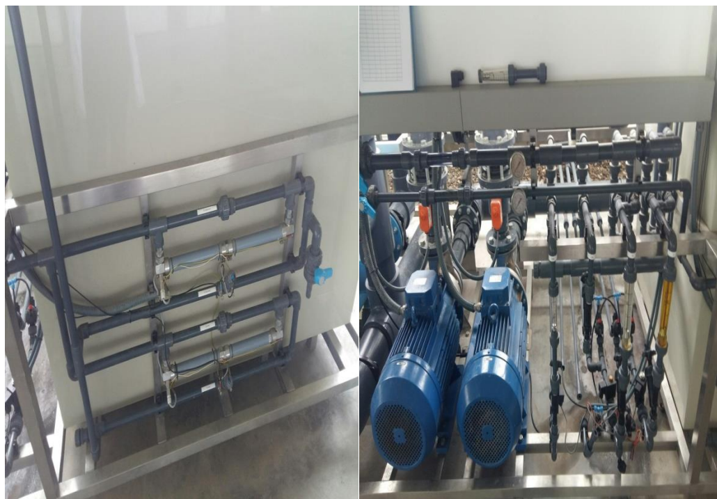
1.4 Сурет - Су тартқыш асинхронды қозғалтқыштар мен пайдалы элементтерді дозаторлайтын қондырғысы
